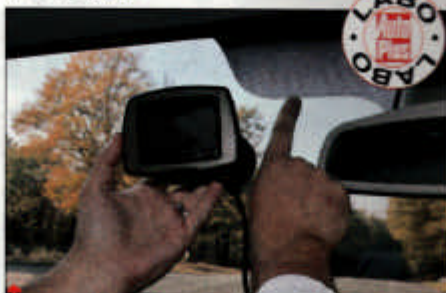
Les pare-brise athermiques disposent d'une "zone neutre" où les GPS fonctionnent.
